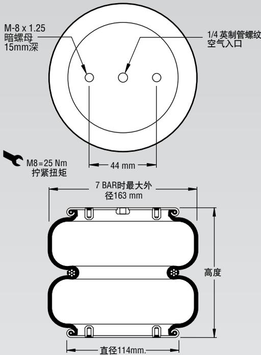
注：图示为缘板气囊。此零件也可提供缘环结构。不包括螺钉。参见第8-10页的说明。
