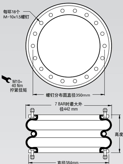
注：图示为缘环气囊。此零件也可提供轧制板结构。参见第11页的说明。
