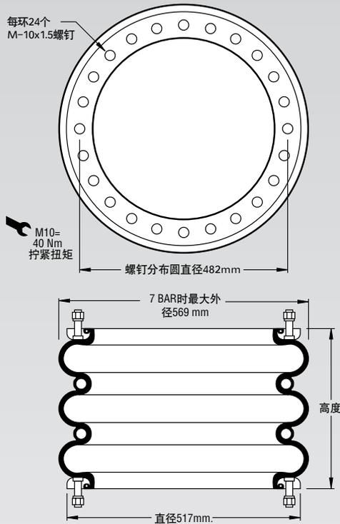
注：图示为缘环气囊。此零件也可提供轧制钣结构。参见第11页的说明。
