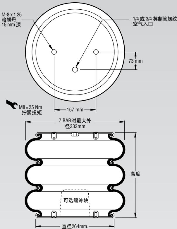
注：图示为缘板气囊。此零件也可提供缘环结构。参见第8-10页的说明。
